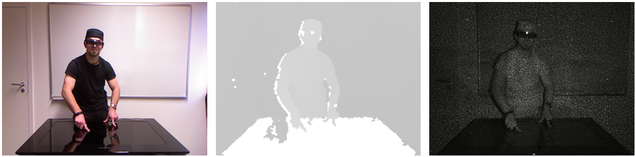
Abbildung 2: Illustration von Marker-basiertem Headtracking mit der Kinect: RGB-Bild (links), intern berechnetes Tiefenbild (Mitte) sowie IR-Bild der Kinect (rechts). Der IR-Marker erscheint als hellster Punkt im IR-Bild und führt zu einer lokalen Störung im berechneten Tiefenbild (weiße Bereiche stellen undefinierte Werte dar).
